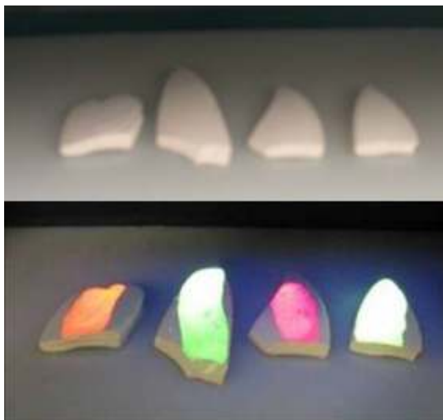
Porcelán felületre felhordott fénypor szuszpenziók látható- és ultra-ibolya fényben
